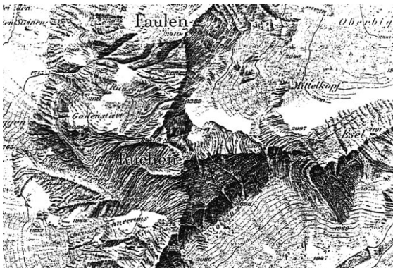
Ilustración 1.7.7: Es mejor interrumpir el dibujo de curvas si vamos a utilizar el roquedo. Las maestras, normalmente se mantendrán
