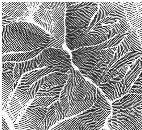
Ilustración 1.4.7: Representación mediante normales de pendiente
