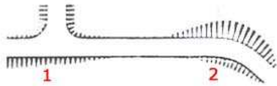
Ilustración 1.4.10: Terraplén (1) y Desmonte (2)
